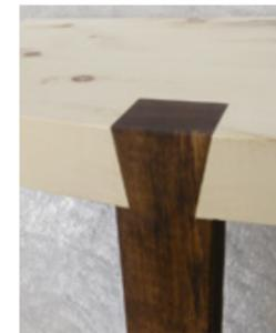
Musterbeine mit Schwalbenschwanzverbindung
