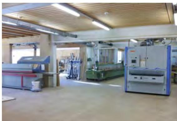
Heute stehen die Schleif-, Kantenleimmaschine und die Irion Längskreissäge im Maschinenraum.
