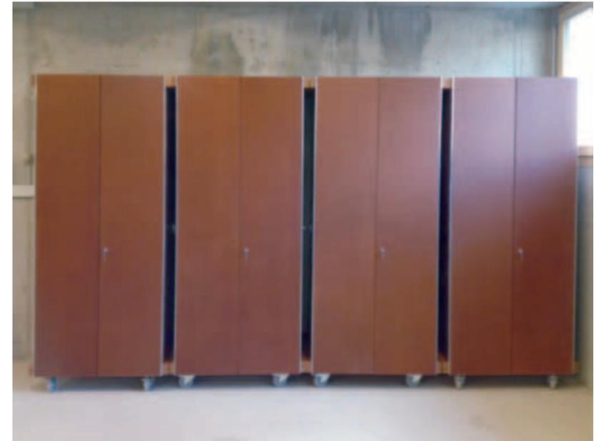
struktors baute ich darauf hin einen der sechs Schränke komplett zusammen, um zu schauen ob alles passt, damit ich alle restlichen fünf Schränke genau gleich produzieren konnte. Es folgten sehr intensive Schleifarbeiten an Kanten, Flächen und Fälzen um eine optimale Oberfläche für die spätere Lackierung zu schaffen. Ein weiteres Highlight war die Lackierung, die ich ausnahmsweise selbst durchführen durfte. Die gesamte Lackierung mit Zwischenschliff verschlang
