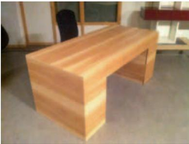
Tino hat einen Schreibtisch als Projektarbeit geplant und ausgeführt. Das Spezielle an diesem Schreibtisch ist, dass er 32 Schubladen hat, auf beiden Seiten jeweils 16. Das bedeutet, dass man von beiden Seiten her am Schreibtisch arbeiten kann. Er brauchte ‚eine Ewigkeit‘, um diese Schubladen zu dübeln und zu verleimen. Der Schreibtisch an sich wurde aus Apfelbaum furnierten Spanplatten gefertigt. Für diese Arbeit gewann Tino ebenso einen Preis von der BDN Stiftung.
